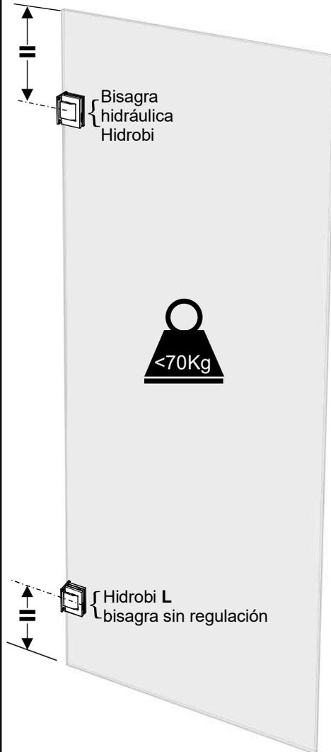
Para puertas con una altura máxima de 3000mm o ancho máximo de 1000mm y grueso de vidrio de 8/10/12mm
